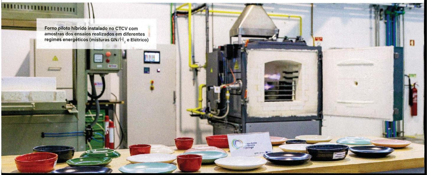
Forno piloto híbrido instalado no CTCV com amostras dos ensaios realizados em diferentes regimes energéticos (misturas GN/H<sub>2</sub> e Elétrico)
